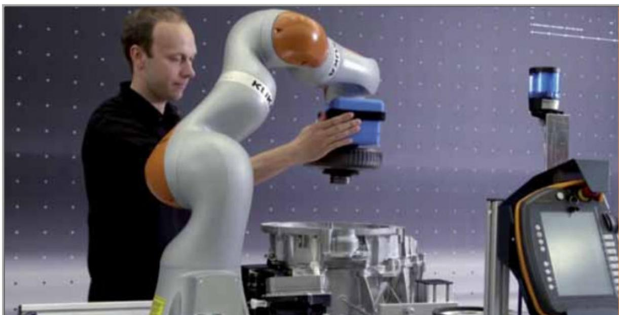
Abbildung 12 Kollaborative Montage eines Doppelkupplungsgetriebes
